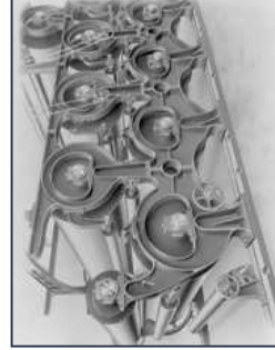
Thune bygde tørkegrupper til både nye maskiner og til mange ombyggingssprosjekter.
